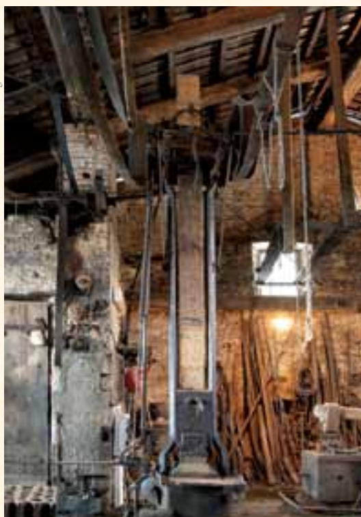
In queste due immagini, macchinari e attrezzi pre-industriali per la lavorazione del ferro conservati presso la Fucina Morino di Mongrando. Qui sopra, in particolare, si osserva un antico maglio a testa d'asino.
