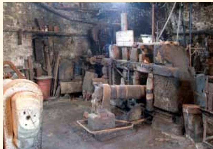
In queste due immagini, macchinari e attrezzi pre-industriali per la lavorazione del ferro conservati presso la Fucina Morino di Mongrando. Qui sopra, in particolare, si osserva un antico maglio a testa d'asino.
